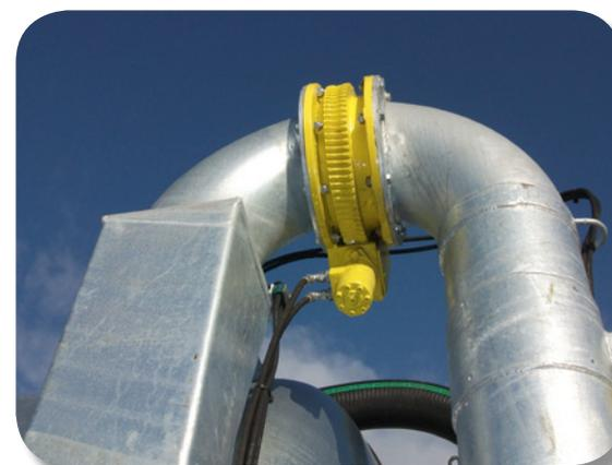
Ralla idraulica Ø 200 - Ø 250
