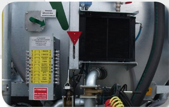
Radiatore con termostato - Indicatore di livello
