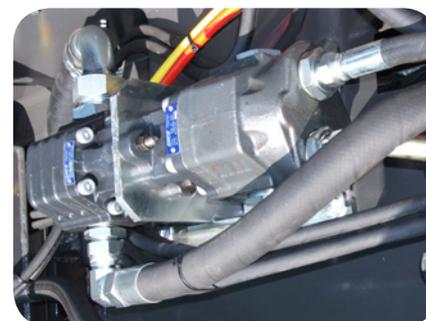
Doppia pompa idraulica
