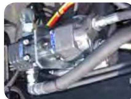
Doppia pompa idraulica
