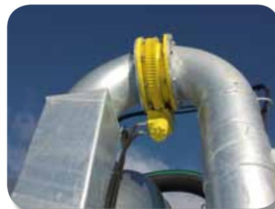
Ralla idraulica Ø 200 - Ø 250
